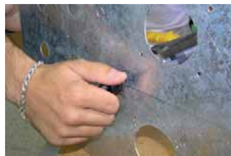
↑ Figura 2.62. Roscado de la matriz de la punzonadora hidráulica.
