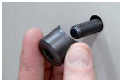
↑ Figura 2.60. Roscado de la matriz del punzón en el orificio del cuadro.
