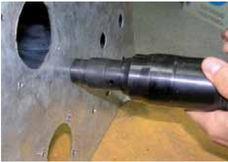
↑ Figura 2.63. Operación de perforado con punzonadora hidráulica.
