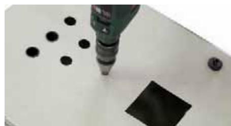
↑ Figura 2.35. Uso de broca escalonada en cuadro eléctrico.
