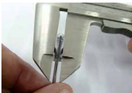
↑ Figura 2.66. Elección de broca para diámetro de remache.
