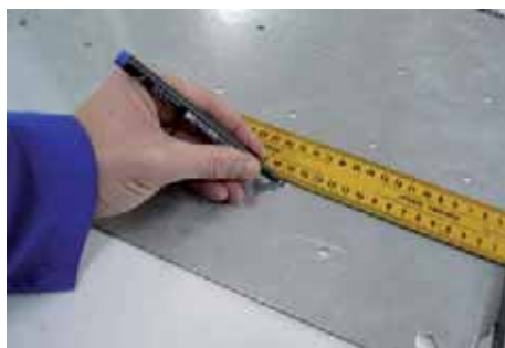
↑ Figura 2.54. Medida y marcado del punto de taladrado.
