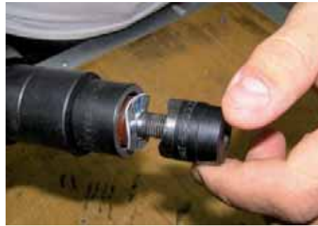
↑ Figura 2.63. Operación de perforado con punzonadora hidráulica.
