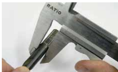
↑ Figura 2.59. Elección de broca para el espárrago del punzón.
