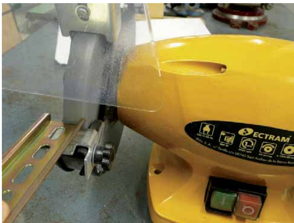
↑ Figura 2.73. Esmerilado del borde del raíl.
