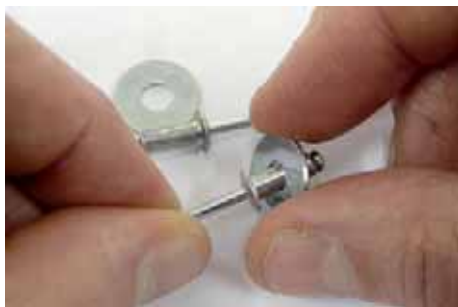
↑ Figura 2.67. Colocación de arandelas en cabeza de remachado.
