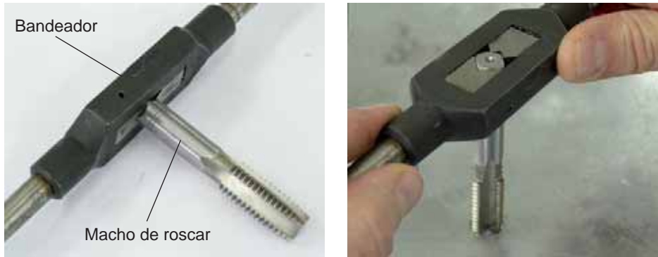
↑ Figura 2.39. Macho de roscar acoplado al bandeador y operación de roscado.
