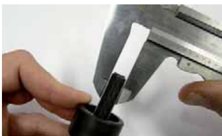
↑ Figura 2.59. Elección de broca para el espárrago del punzón.
