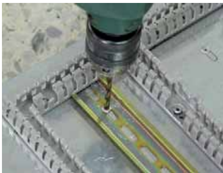
↑ Figura 2.69. Taladrado para retirar remache.
