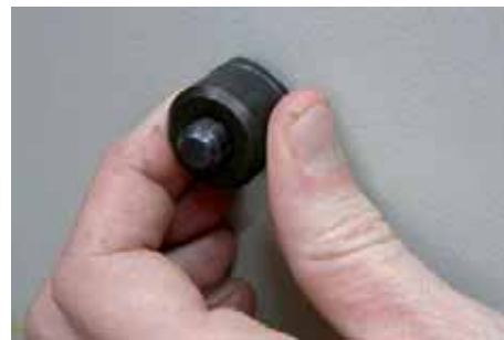
↑ Figura 2.60. Roscado de la matriz del punzón en el orificio del cuadro.
