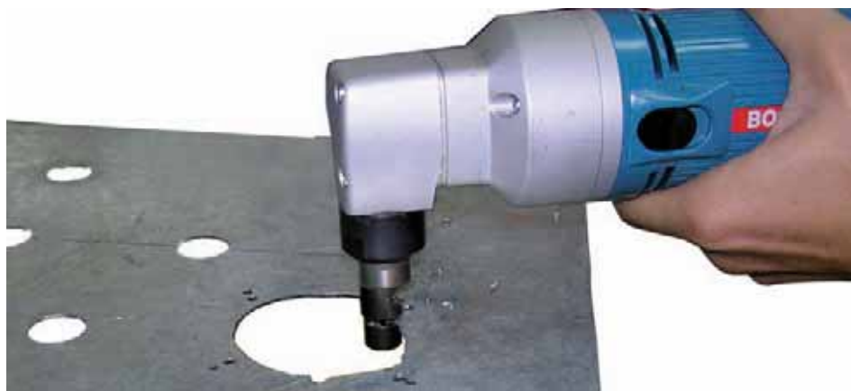
↑ Figura 2.27. Uso de la roedora para hacer un orificio de grandes dimensiones en chapa.
