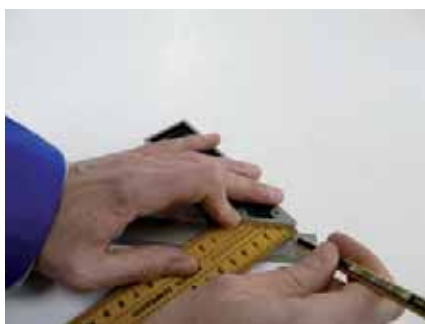
↑ Figura 2.74. Marcado de canaleta con ayuda del inglete de la escuadra.
