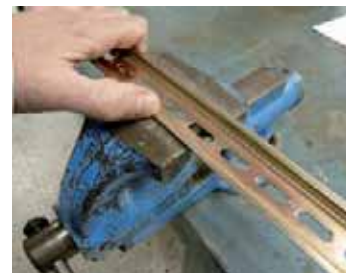
↑ Figura 2.71. Forma incorrecta de sujetar el raíl en el tornillo de banco.
