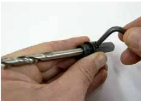
↑ Figura 2.64. Fijación de la corona en el husillo.
