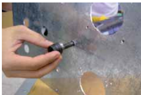
↑ Figura 2.62. Roscado de la matriz de la punzonadora hidráulica.
