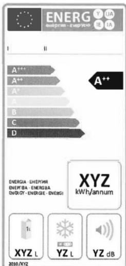
A ETIQUETA ENERGÉTICA ES UN INSTRUMENTO DE USO OBLIGATORIO QUE PERMITE CONOCER DE FORMA RÁPIDA Y VISUAL LA EFICIENCIA ENERGÉTICA DE UN APARATO ELECTRODOMÉSTICO.
