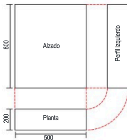
Figura 3.21. Ejemplo de las vistas y cotas mínimas necesarias para definir el cofre de un cuadro eléctrico.
