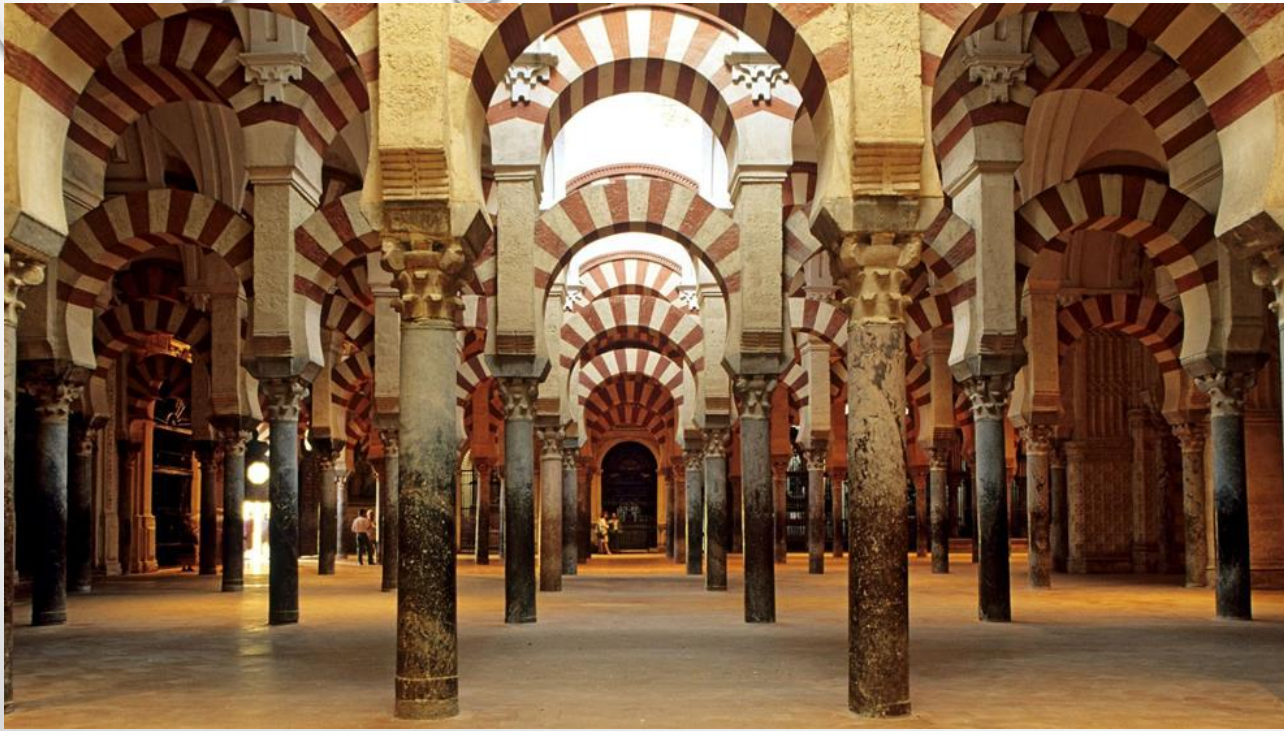
Mesquita de Córdoba (detalle da sala de oracións). Arte califal. Destacan as columnas reaproveitadas, a dobre arcada (inferior de ferradura e superior de medio punto) para dar máis altura ao edificio, e a combinación de doelas brancas e vermellas.
