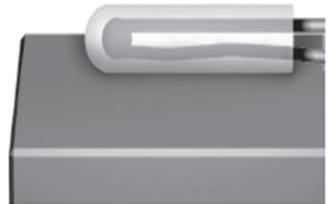
**Cuando la unión se calienta algunos electrones de la zona caliente se mueven a la zona fría** (efecto Seebeck). Cada metal tiene una respuesta diferente a la temperatura, lo que **genera una tensión** (milivoltios) **que se mide en la unión fría** (cables sueltos). **La tensión generada varía en función de la temperatura**. Después, otro dispositivo transforma la tensión (mV) en unidades de temperatura (°C).
