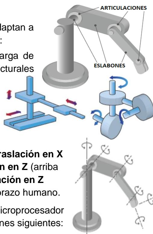
Un robot puede tener como máximo **6 grados de libertad** (GDL): **traslación en X** (adelante y atrás), **traslación en Y** (izquierda y derecha), **traslación en Z** (arriba y abajo), **rotación en X** (balanceo), **rotación en Y** (cabecero) y **rotación en Z** (guiñada). Con 6 GDL se puede reproducir los movimientos de un brazo humano.
