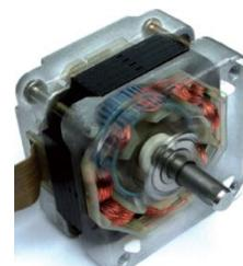
**El ángulo de paso** suele variar desde 1,8° (necesita 200 impulsos para girar una vuelta) hasta 15° (necesita 24 impulsos).
