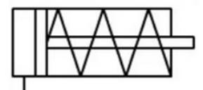
Cuando el aire fluye en su interior, el desplazamiento del émbolo mueve un vástago capaz de realizar un trabajo. Cuando cesa el flujo de aire, el émbolo y el vástago regresan a su posición inicial mediante un muelle o alguna otra fuerza exterior.
