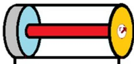
**La superficie en el retroceso ( $S_r$ )**, coloreada de azul celeste en la imagen, es la superficie sobre la que empuja el fluido durante el retroceso. Se obtiene restándole a la superficie en el avance ( $S_a$ ) la superficie circular del vástagos ( $S_v$ ):
