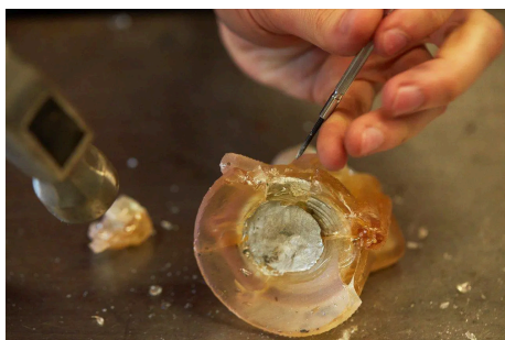
Los moldes sacrificables quedan destruidos durante el proceso de desmoldeo.
