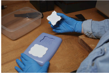
Un molde de silicona de una pieza que se puede usar para diseños con una cara plana y sin socavados profundos.
