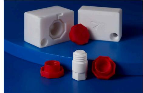
Diseños más complejos como este tapón con una rosca y socavados a menudo requieren moldes de varias piezas, con insertos o machos de acción lateral.
