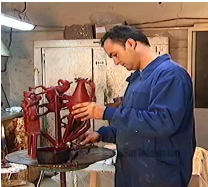
Fotograma del vídeo: Técnica de fundición en bronce a la cera perdida Disponible en: https://www.youtube.com/watch?v=MSqazcApFTk Consulta del 02/03/2020
