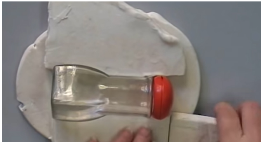
Fotograma del vídeo: Molde en bloque Disponible en: https://www.youtube.com/watch?time_continue=450&v=y2cV2kMrzCk Consulta del 02/03/2020
