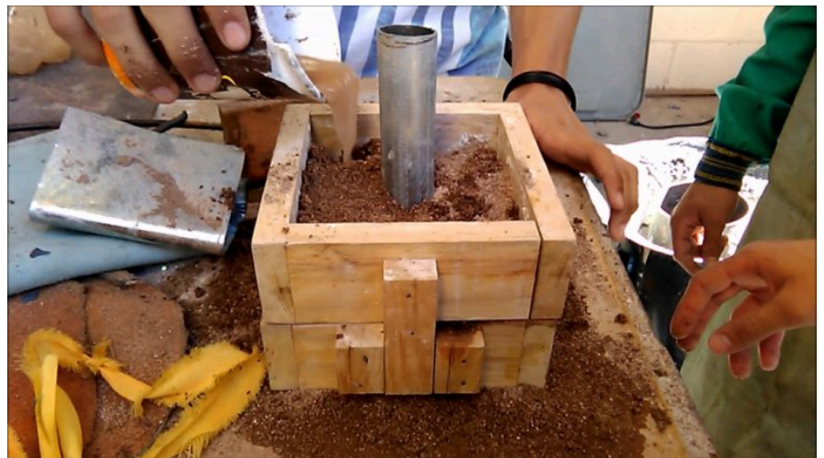
Fotograma del vídeo: Fundición con molde de arena Disponible en: https://www.youtube.com/watch?v=LX5uUE1YGNl Consulta del 02/03/2020
