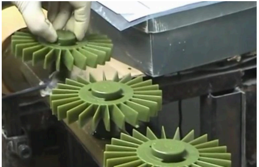
Fotograma del vídeo: Microfusión. Fundición a la cera perdida Disponible en: https://www.youtube.com/watch?v=FAh5DTebL5k Consulta del 02/03/2020
