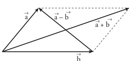
Los vectores  $\vec{a} + \vec{b}$  y  $\vec{a} - \vec{b}$  son las diagonales del paralelogramo determinado por  $\vec{a}$  y  $\vec{b}$ . Por tanto, están en el plano definido por  $\vec{a}$  y  $\vec{b}$ . Y el vector  $\vec{a} \times \vec{b}$  es perpendicular a dicho plano.
