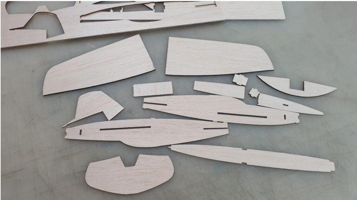
Con esta plantilla, el corte láser con Mr Beam es extremadamente fácil. Coloca el material, en este caso madera de balsa, en el área de trabajo y arrastra la plantilla para el planeador de lanzamiento a la interfaz del software. Para la madera de balsa, tenemos ajustes preestablecidos adicionales para el láser.
