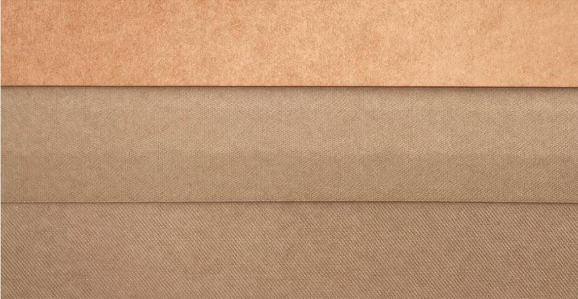
Paquete de prueba KRAFTPLEX, paquete de 15 (0,5, 1,0 y 1,5 mm)
