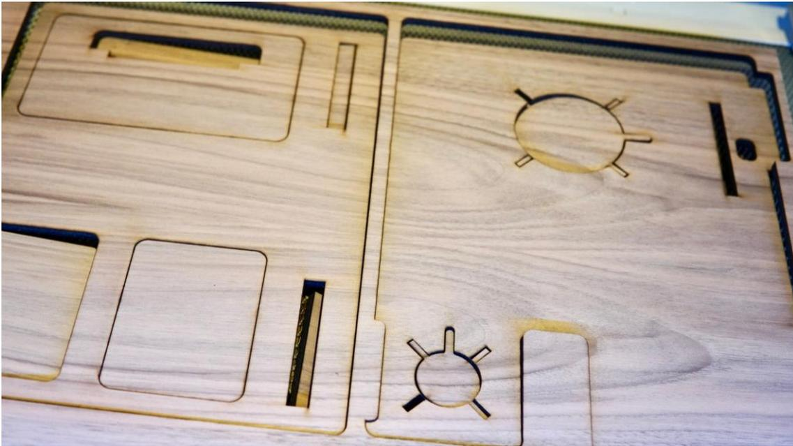
Ahora para hacer el resto de elementos, corta con láser la placa base (líneas de corte verdes) y los soportes para los cargadores MagSafe de madera contrachapada de álamo o abedul de 3 mm. Para las inserciones de fieltro se recomienda fieltro de 1-2 mm .
