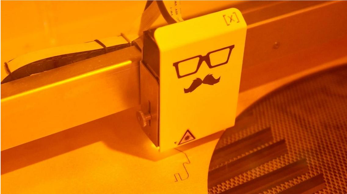
Después de enfocar, la Mr Beam puedes comenzar el trabajo de cortado láser.
