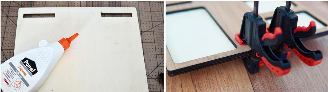
Primero pega los paneles del piso juntos. Para hacer esto, aplica pegamento y fija ambos paneles con abrazaderas. Luego, aplica pegamento para madera a los soportes MagSafe, alinéalos y finalmente arregla todo con los cuatro elementos enchufables y las abrazaderas.
