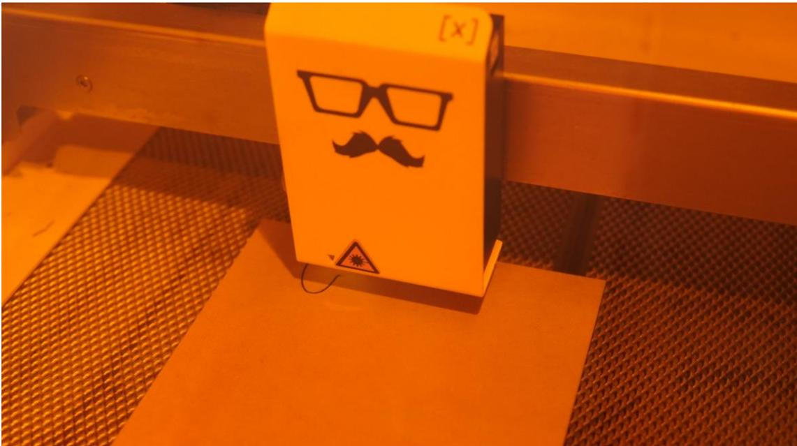
Los ajustes del láser para Kraftplex ya están almacenados, pero con el cabezal [x] recomendamos reducir las pasadas a "1" y reducir un poco la velocidad, de lo contrario puede suceder rápidamente que el Kraftplex se corte después de la primera pasada y los elementos luego quedar sueltos y caer al fondo de la cortadora. Con otra pasada, el rayo láser se proyectaría sobre los elementos terminados y dejaría un grabado no deseado.
