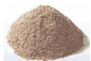
Son los fabricados mediante la aplicación de un adhesivo, presión y calor sobre las partículas de madera.
