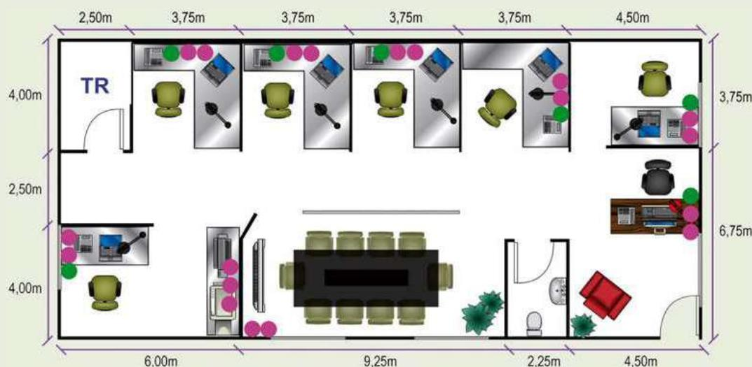
2. Planificamos el cableado desde cada una de las áreas de trabajo al TR. El medio de canalización a utilizar será de superficie, empleando canaleta y cajas de superficie para instalar las tomas de voz y datos junto con tomas eléctricas. Para facilitar la tarea, asignamos un código a cada espacio.
