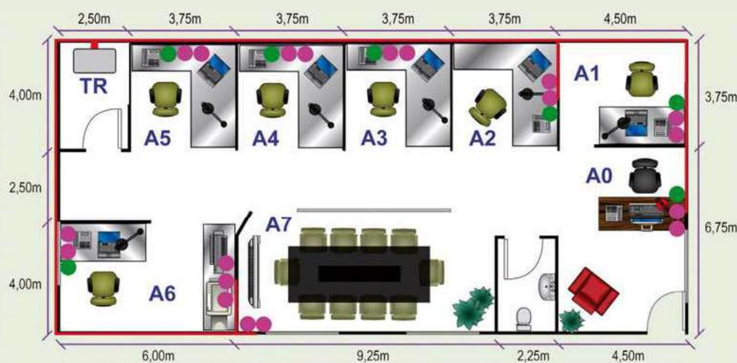
3. Hacemos el cálculo de cableado necesario. No sabemos si nuestro cliente va a querer telefonía analógica o IP, así que le implementamos el sistema de voz con cable UTP y conectores RJ-45. Si decide telefonía analógica solo utilizaremos el par A-BA.
