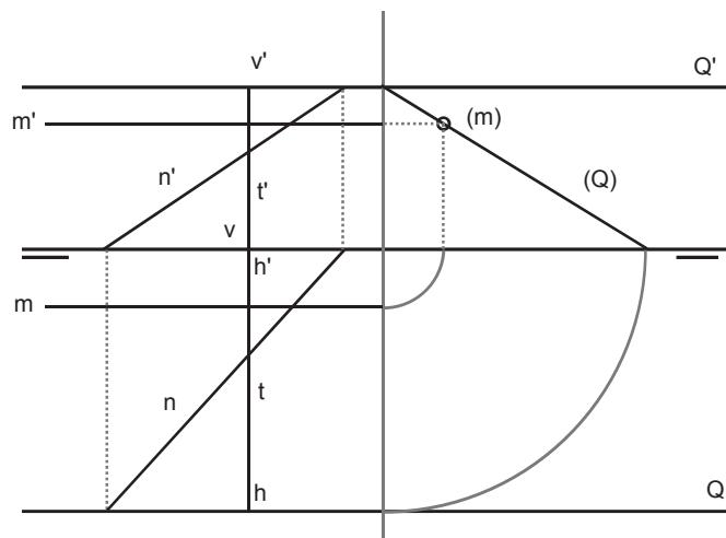
Dado el plano de perfil Q, determina una recta R de punta y una recta vertical S, ambas se deben cortar en un punto A, tambien perteneciente a Q, que tiene una cota de 15 mm. y un alejamiento de 5 mm. Por A traza una recta de perfil T que forma  $60^\circ$  con PH y  $30^\circ$  con PV y determina sus trazas.
