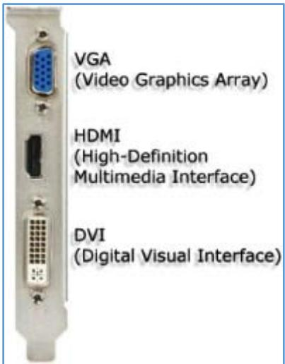
**Puerto VGA o estándar:** Es el conector básico de video que conecta por cable el PC y el monitor.
