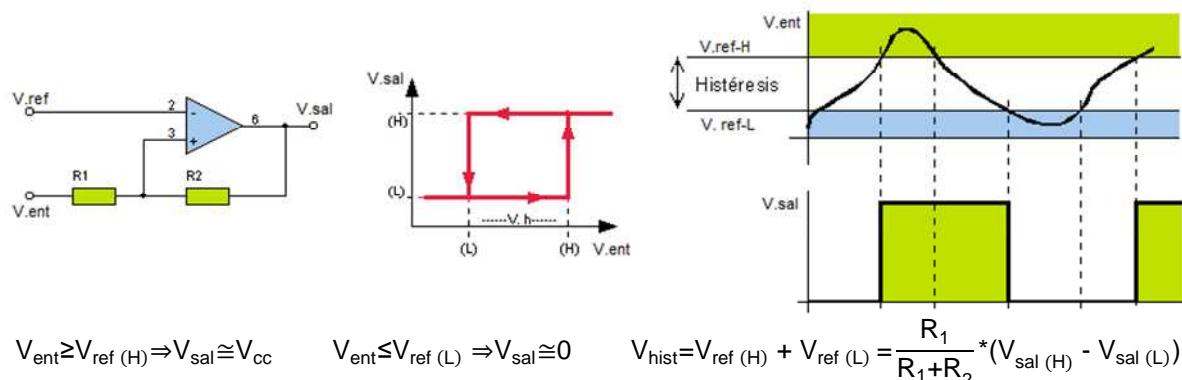
**Comparador con histéresis inversor.** La señal entrada ( $V_{ent}$ ) se aplica sobre el terminal inversor (-), siendo el no inversor (+) al que se le aplica la tensión de referencia ( $V_{ref}$ ). Las fórmulas descritas para el comparador con histéresis no inversor son también aplicables a este tipo de circuito.
