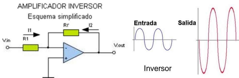
Como la impedancia de las entradas es muy grande, las corrientes ( $I_1$  e  $I_2$ ) en ambas resistencias se igualan. Por lo tanto la ganancia del amplificador queda determinada principalmente por la relación de dichas resistencia, tal como se muestra en las siguientes expresiones.
