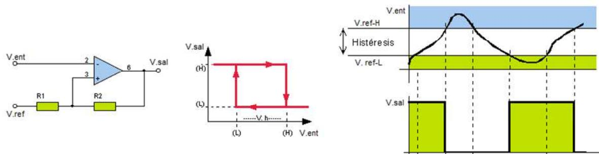
Los circuitos comparadores tienen diversas aplicaciones, por ejemplo como temporizadores a la activación o a la desactivación. También como conmutadores que se accionan automáticamente por las variaciones en transductores sensibles a una magnitud física (luz, temperatura, presión, etc.), tal es el caso del "interruptor crepuscular para el encendido automático del alumbrado".
