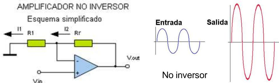
La resistencias  $R_1$  y  $R_r$  forman un divisor de tensión, con el cual y dependiendo del valor de dichas resistencias, se fija la ganancia resultante del circuito.
