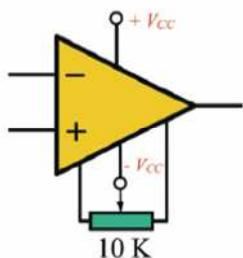
Amplificador equilibrado: si  $V_{in} = 0 \Rightarrow V_+ = V_- \Rightarrow V_{out} = 0$
