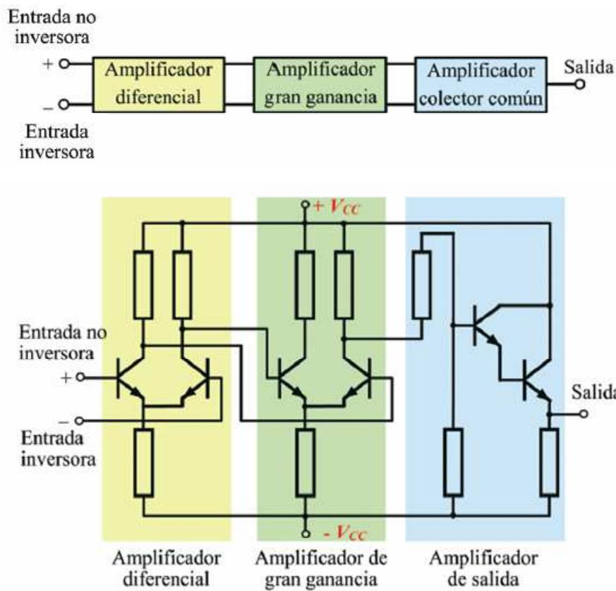
La primera etapa consta de un amplificador diferencial; elemento esencial para conseguir que la señal de salida dependa de la diferencia de las señales aplicadas a la entrada. La segunda etapa amplificadora es la que proporciona una alta ganancia. La etapa de salida es un amplificador de baja potencia, habitualmente en colector común con par Darlington con baja impedancia de salida.
