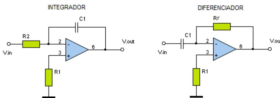
Con estas modificaciones se logra, según el caso, una señal de salida proporcional a la integral o a la derivada de la señal de entrada.
