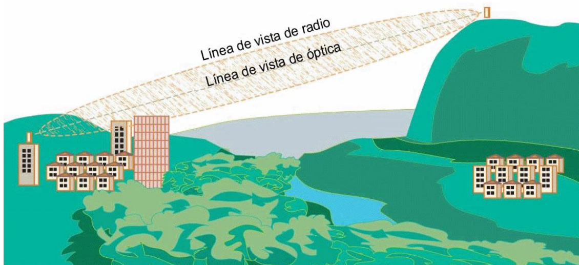
Figura 23: Liña visual óptica e liña visual de radio (LOS).
