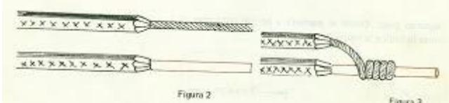
**Tercer paso: Doble la punta del alambre sobre las vueltas de cable, apretándola con los alicates, como lo muestra la figura 1.**
