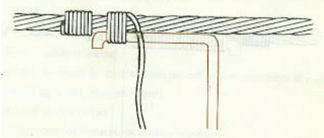
**b) Unión sujetadora**
