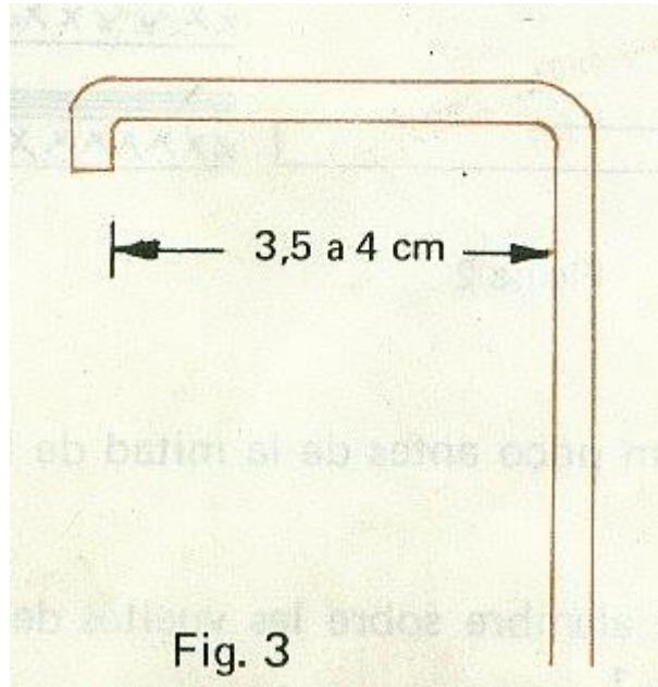
**Tercer piso:** Asliste un trozo de alambre de cobre del N° 18 para efectuar el enrollado.
