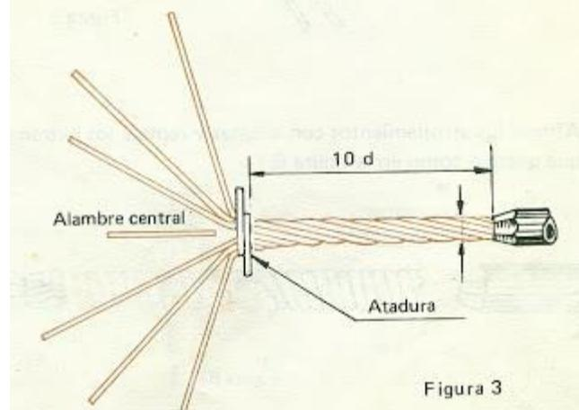
**4. Paso: Corte el alambre central de cada uno de los cables, junto a la atadura.**
