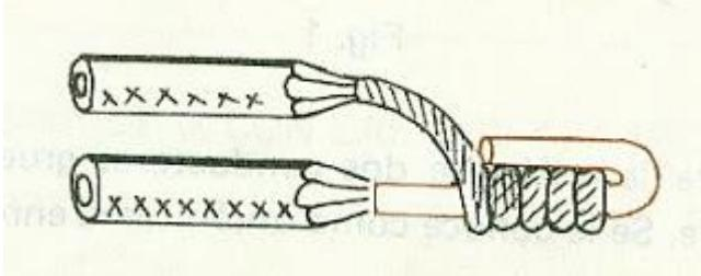
**Se utiliza para la unión final entre dos conductores por ejemplo un cordón y un alambre sólido o también cuando los conductores son dos alambres y sus secciones son diferentes.**
