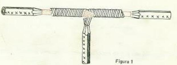
Este tipo de derivación se utiliza en cables de secciones medianas, pudiéndose realizar de otra forma, como se muestra en la prolongación de cables gruesos.
