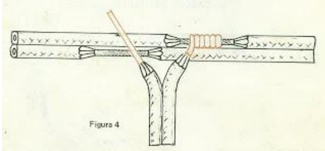
Tome el otro extremo del conductor y enróllelo sobre el otro corte, en sentido contrario al anterior, de tal manera que quede como el de la figura 1.
