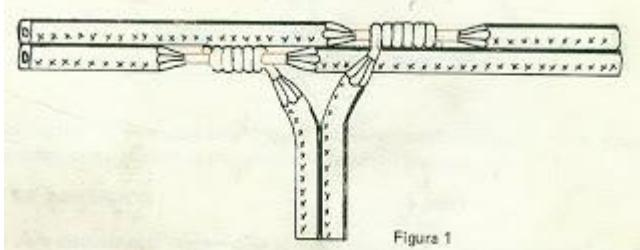
**Este empalme se utiliza cuando en una instalación con cable Duplex se desea derivar una línea.**
