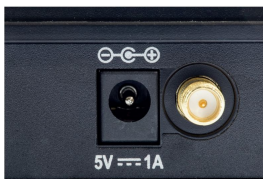
Figura 5.11. Detalle de la toma de corriente (jack hembra) de un equipo electrónico a tensión reducida.
