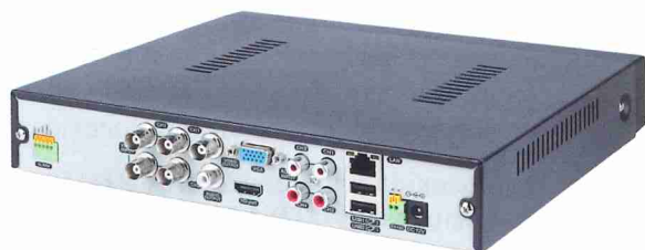
Figura 2.15. Panel posterior de conexión de un dispositivo DVR genérico.
