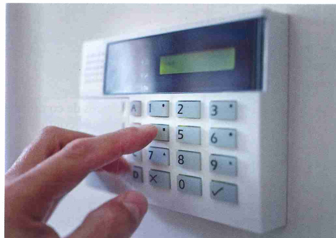
Figura 2.24. Centralita de alarma inalámbrica con panel de control incorporado.
