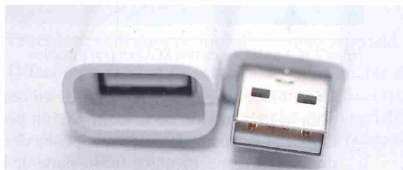
Figura 2.17. Conectores de tipo USB-Type A. Hembra y macho, respectivamente.
