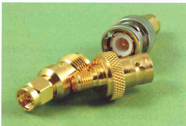
Figura 2.16. Conectores de tipo BNC. Roscado, hembra y macho respectivamente.
