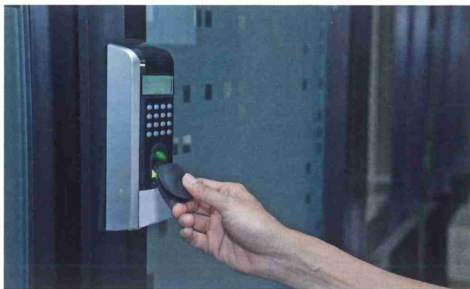
Figura 2.31. Elemento híbrido de control de acceso. Lector NFC con teclado numérico.
