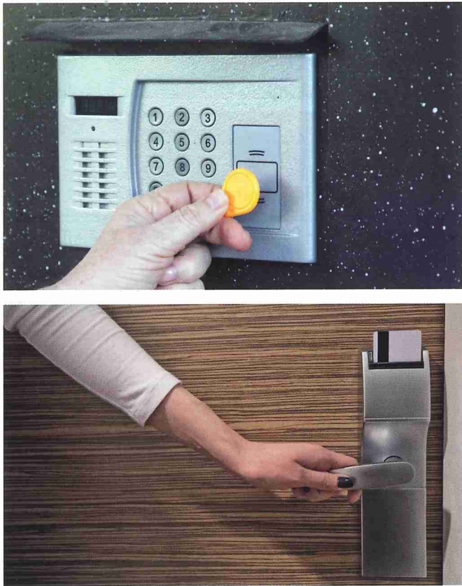
Figura 2.30. Lectores de control de acceso: lector RFID (arriba) y lector de tarjetas con banda magnética (abajo).
