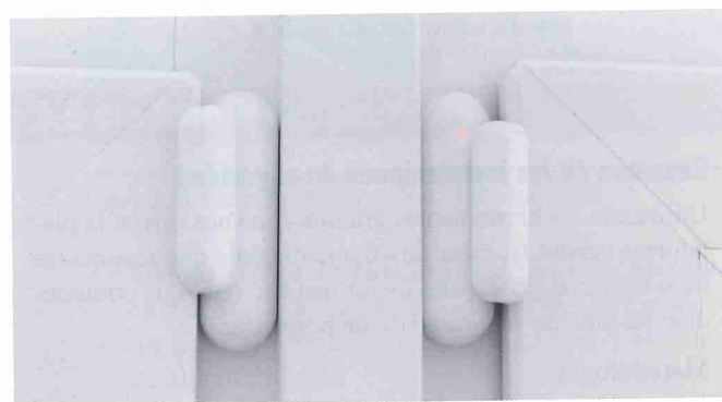
Figura 2.23. Dos ejemplos de detectores antiintrusión. Arriba, detectores PIR por infrarrojos. Abajo, detectores magnéticos de apertura de puertas.
