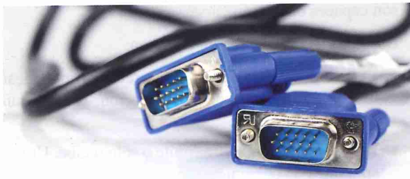
Figura 2.19. Conectores macho de tipo VGA (SVGA).
