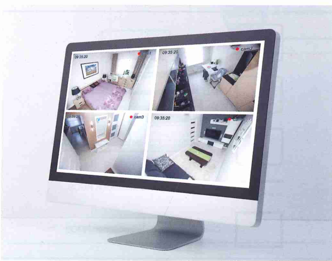
Figura 2.43. Imagen resultante de un DVR con función QUAD 2x2.
