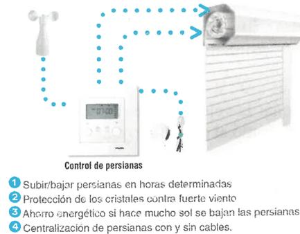
Figura 2.86. Posibles soluciones de automatización de persianas. (Cortesía de SCHNEIDER ELECTRIC).
