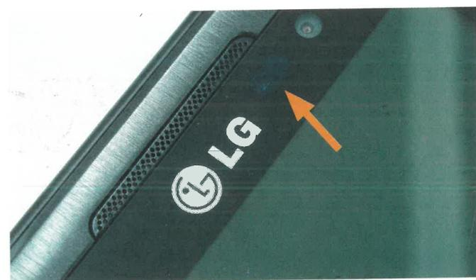
Figura 2.49. Detalle del detector fotoeléctrico en teléfono inteligente LG Optimus.
