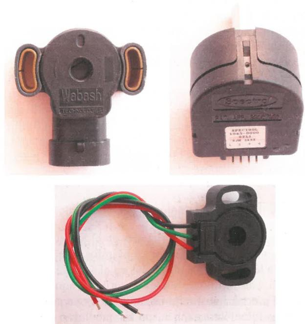
Figura 2.40. Algunos sensores de inclinación.
