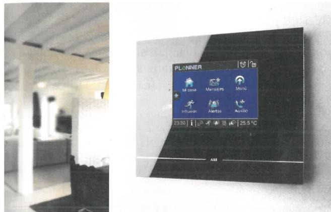
Figura 2.9. Detalle de central preprogramada PLANNER en hogar. (Cortesía de NIESSEN-ABB).
