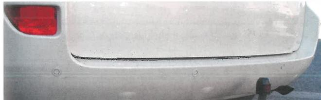
Figura 2.54. Vehículo con sensores de ultrasonidos usados en la maniobra de aparcamiento.
