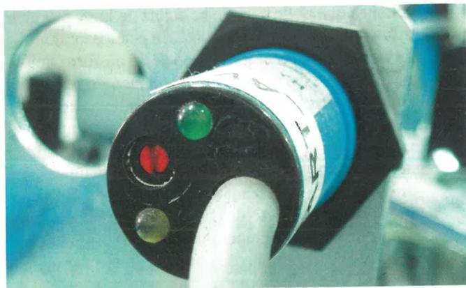
Figura 2.48. Detalle del selector de sensibilidad de un detector fotoeléctrico de proximidad.
