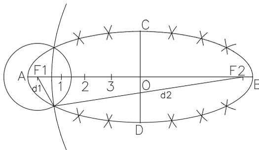
Dibujados los ejes y determinados los focos, situamos arbitrariamente puntos entre uno de los focos y el centro de la elipse sobre el eje mayor (1, 2, 3, etc.).
