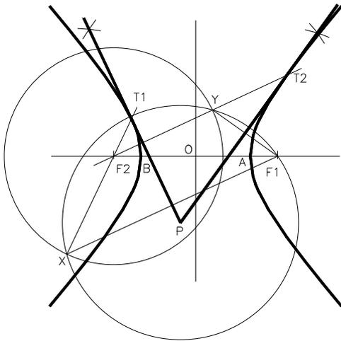
Como en la elipse, trazamos una circunferencia de centro en P dado, que pase por uno de los focos (F1), cortará a la circunferencia focal (radio AB) trazada con centro en el otro foco (F2) en X e Y, que como sabemos son los puntos simétricos del foco F1 respecto de las rectas tangentes. Trazamos las mediatrices de los segmentos XF1 e YF1 y obtenemos las rectas tangentes buscadas. Los puntos de tangencia se encuentran en la intersección de la curva y la prolongación de los segmentos XF2 e YF2.
