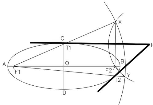
elipse desde P buscadas. Los puntos de tangencia  $T_1$  y  $T_2$  de estas tangentes, con la elipse, están en la intersección de los segmentos  $F_1X$  y  $F_1Y$  con la propia elipse. Trabajando con la circunferencia focal de centro  $F_2$ , obtenemos las mismas soluciones
