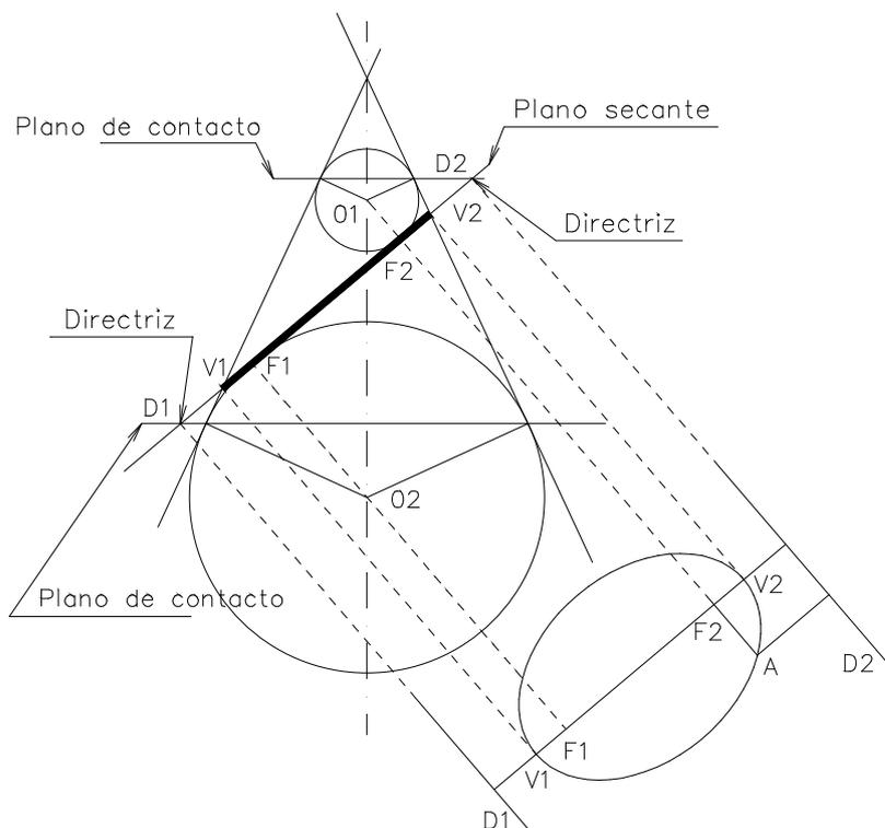
La curva sección resultante en el dibujo es la Elipse pues el ángulo entre el plano secante y el eje es mayor que entre el eje y las generatrices del cono. La Elipse y la Hipérbola tienen dos rectas directrices y dos focos. La Parábola tiene un solo foco y una sola recta directriz pues corta solamente a una rama del cono por ser paralelo el plano secante a una de las generatrices de este.
