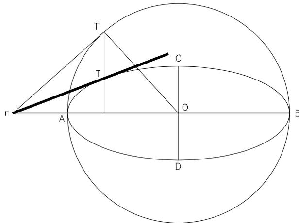
*La construcción se basa en la afinidad entre la circunferencia y la elipse, T y T' son afines siendo el eje mayor el de afinidad, la dirección T'T y n un punto doble.*
