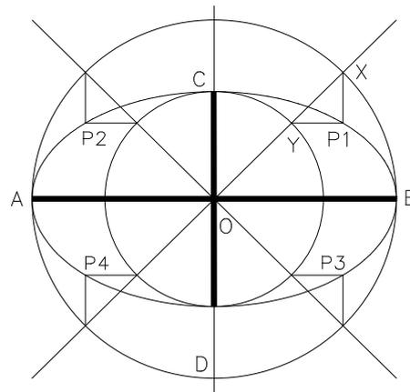
*La construcción se basa en la afinidad existente entre la circunferencia de radio mayor y la elipse, donde el eje de afinidad coincide con el mayor de la elipse y la dirección de afinidad es normal a este.*
