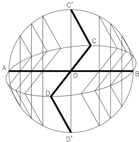
Trazamos la circunferencia de diámetro AB. Dividimos el diámetro en cualquier número de partes por donde trazamos cuerdas de la circunferencia normales a AB, y su diámetro perpendicular C'D'.
