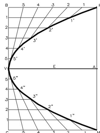
segmento BC, las primeras divisiones las unimos con V y por el resto trazamos paralelas al eje. Donde se cortan las correspondientes (ver el dibujo) obtenemos puntos de la curva.
