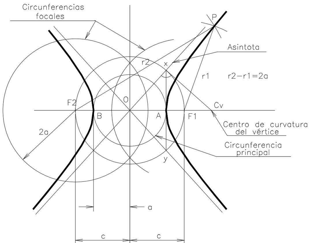
Se denominan **radios vectores** ( $r_1$  y  $r_2$ ) a los segmentos  $F_1P$  y  $F_2P$ , siendo P un punto de la curva. Su diferencia es constante para cualquier punto de la curva e igual a la magnitud del eje mayor ( $r_1 - r_2 = cte = 2a$ ).
