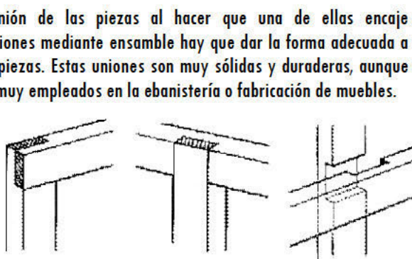
Ensamblaje a media madera
