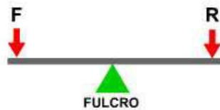
Fig15: Palanca primer grado
