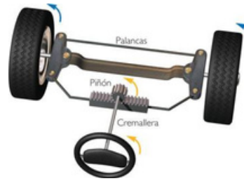
Fig 40: Sistema dirección automóvil.
