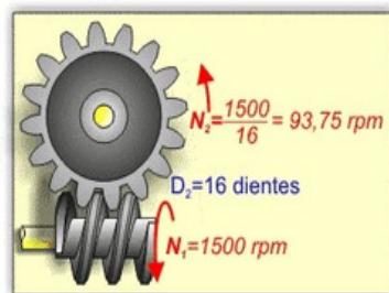
Fig36:Sistema tornillo sinfín corona
