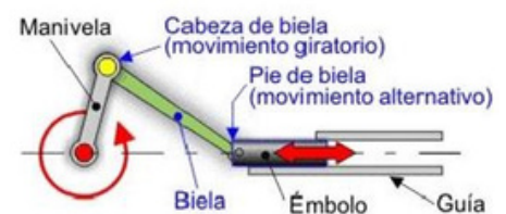
Fig 45: Sistema Biela-Manivela
