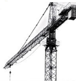
Fig 27: Las grúas son estructuras realizadas a base de una retícula espacial de perfiles triangulados.
