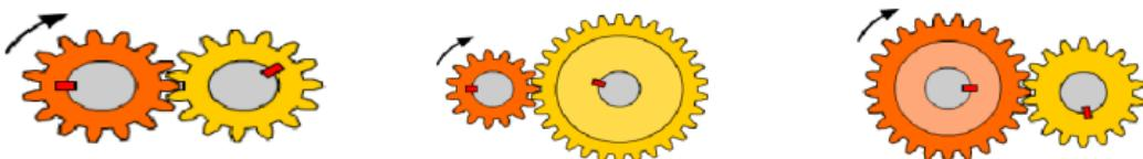
4. A la vista del sistema mostrado (motriz 12 y conducida 20). A) Calcula la velocidad del engranaje conducido, la velocidad del motriz es de 1200 rpm. B) Calcula cuál sería la velocidad del engranaje motriz, si la velocidad del conducido fuese 150 rpm. (Sol: 720 rpm y 250 rpm)
