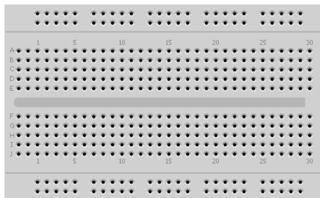
Las patillas de conexión de los componentes se insertan en las ranuras de la placa protoboard. Ojo, las ranuras están conectadas eléctricamente (cortocircuitadas) como se indica en la siguiente figura:
