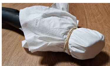
Figura 30. Colocación del filtro para aspirar aire del suelo y área del pañuelo que tendremos que colocar después de cara al detector para la medida
