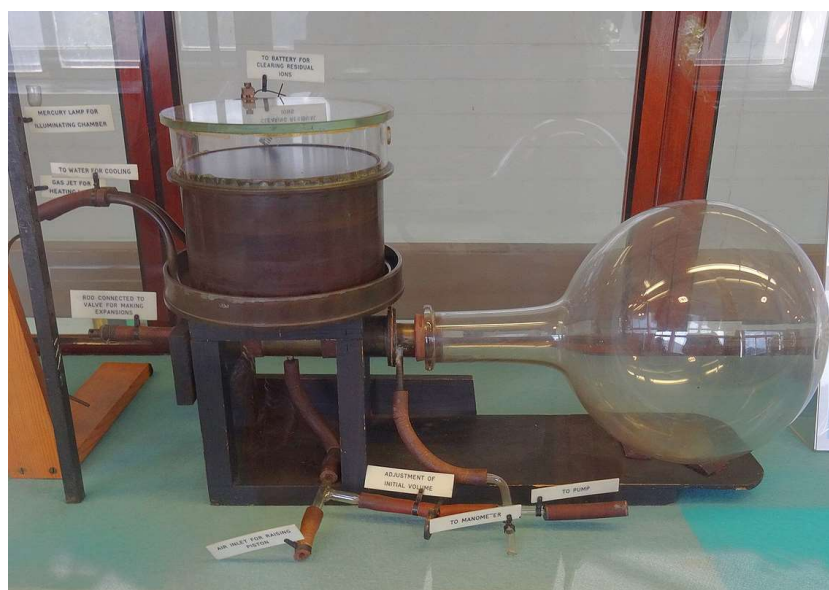
Figura 6, Cámara de niebla de C.R.W. Wilson (1911) [7]
