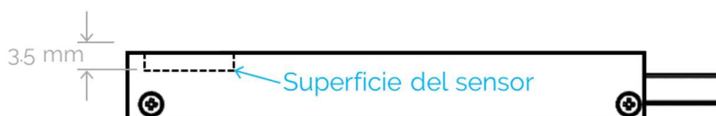
Figura 45. Distancia mínima a la superficie del sensor del MiniPIX
