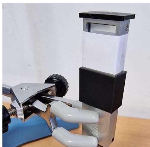
Figura 48. Absorción de partículas alfa al colocar un trozo de papel cubriendo parcialmente el sensor
