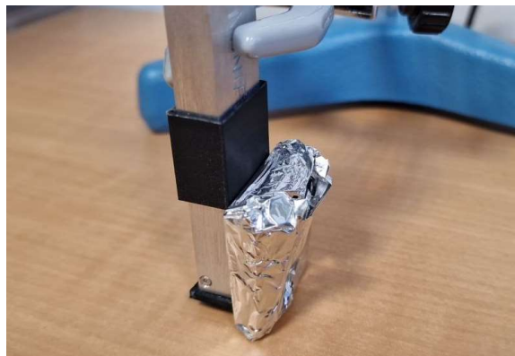
Figura 50. Primera capa de papel de aluminio (izquierda) y colocación de la muestra frente al detector
