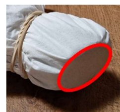
Figura 30. Colocación del filtro para aspirar aire del suelo y área del pañuelo que tendremos que colocar después de cara al detector para la medida
