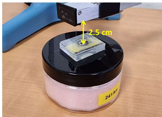
Figura 40. Colocación del sensor y fuente radiactiva (la fuente puede variar)
