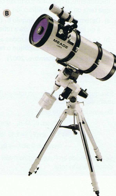
Figura 8.112. Telescopio reflector. Os raios paralelos procedentes dun obxecto afastado reflíctense no espello cóncavo (primario) e, concentrados, reflíctense nun espello plano (secundario), inclinado 45^\circ , tras o cal converxen nun punto que resulta ser o foco da lente ocular.
