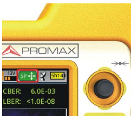
Figura 16. Joystick con función SP (selección de Span)
