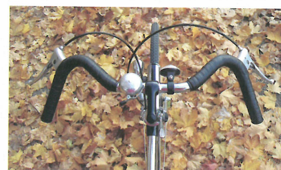
Fig. 1.17 Debemos aplicar ese par de fuerzas de sentidos opuestos para que el manillar de la bici gire.
