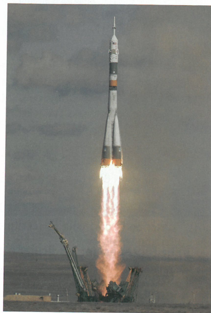
Fig. 1.21 El lanzamiento de un cohete espacial se basa en la conservación de su cantidad de movimiento.
