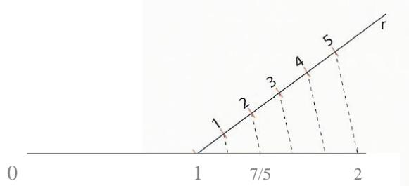
Trazando una recta  $r$  que pase por O, llevamos 5 segmentos iguales sobre  $r$  a partir de O. Unimos el punto 5 con U y trazamos paralelas a ésta pasando por 4, 3, 2 y 1. Los segmentos determinados en OU son iguales y dan lugar a las fracciones  $1/5, 2/5, 3/5$  y  $4/5$ .
