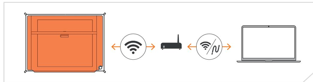
Para la primera instalación, debe conectarse mediante las **opciones de conexión A o B** para acceder al cuadro de diálogo de bienvenida de Mr Beam en el que puede configurar su WLAN.
