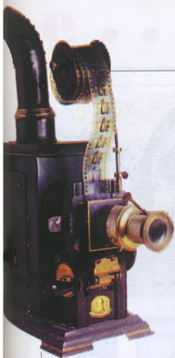
Aparello de proxección similar ó empregado polos LUMIERE.
