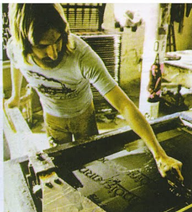
Aplicación de tinta coa espátula no proceso da SERIGRAFÍA.
