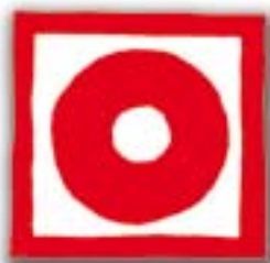
Pulsador de incendio
