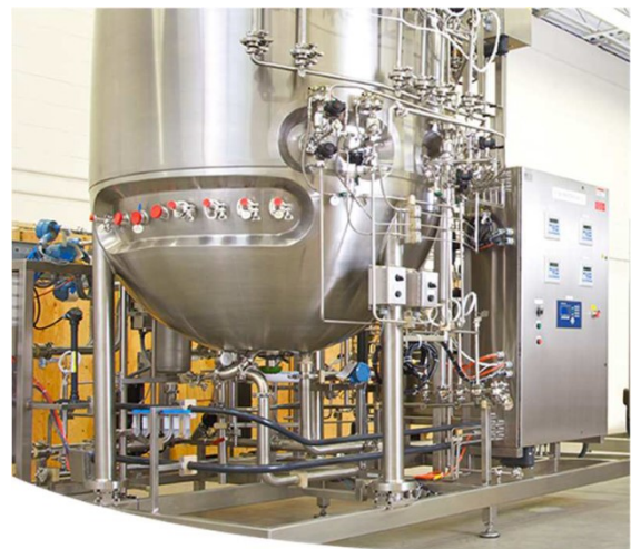
Figura 21.9. Un biorreactor en una industria y Figura 21.10. Un esquema de su funcionamiento.
