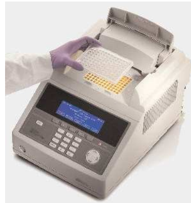
Imaxe 15.5. O termociclador é o encargado de realizar os cambios de temperatura necesarios na PCR.
