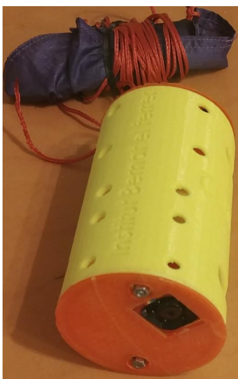
Base estructura, alojamiento mini cámara
