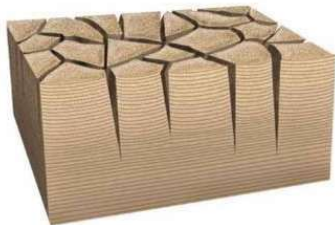
Fendas d. desecamento
