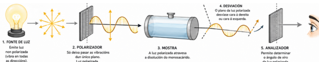
Fig. 7.- Funcionamento do polarímetro. Este instrumento mide a capacidade dunha substancia para desviar a luz polarizada.
