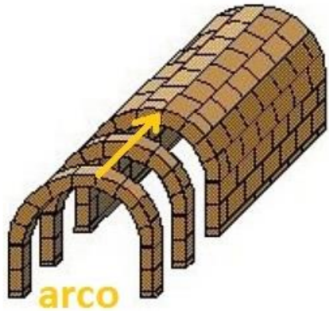
Bóveda de cañón
