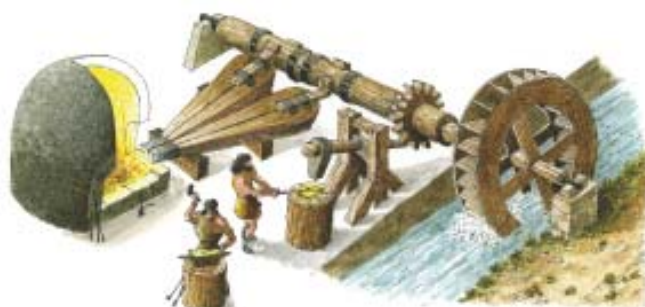
Fig 1: Fragua hidráulica. La fuerza del agua movía el martillo, facilitando la labor para elaborar todo tipo de herramienta
