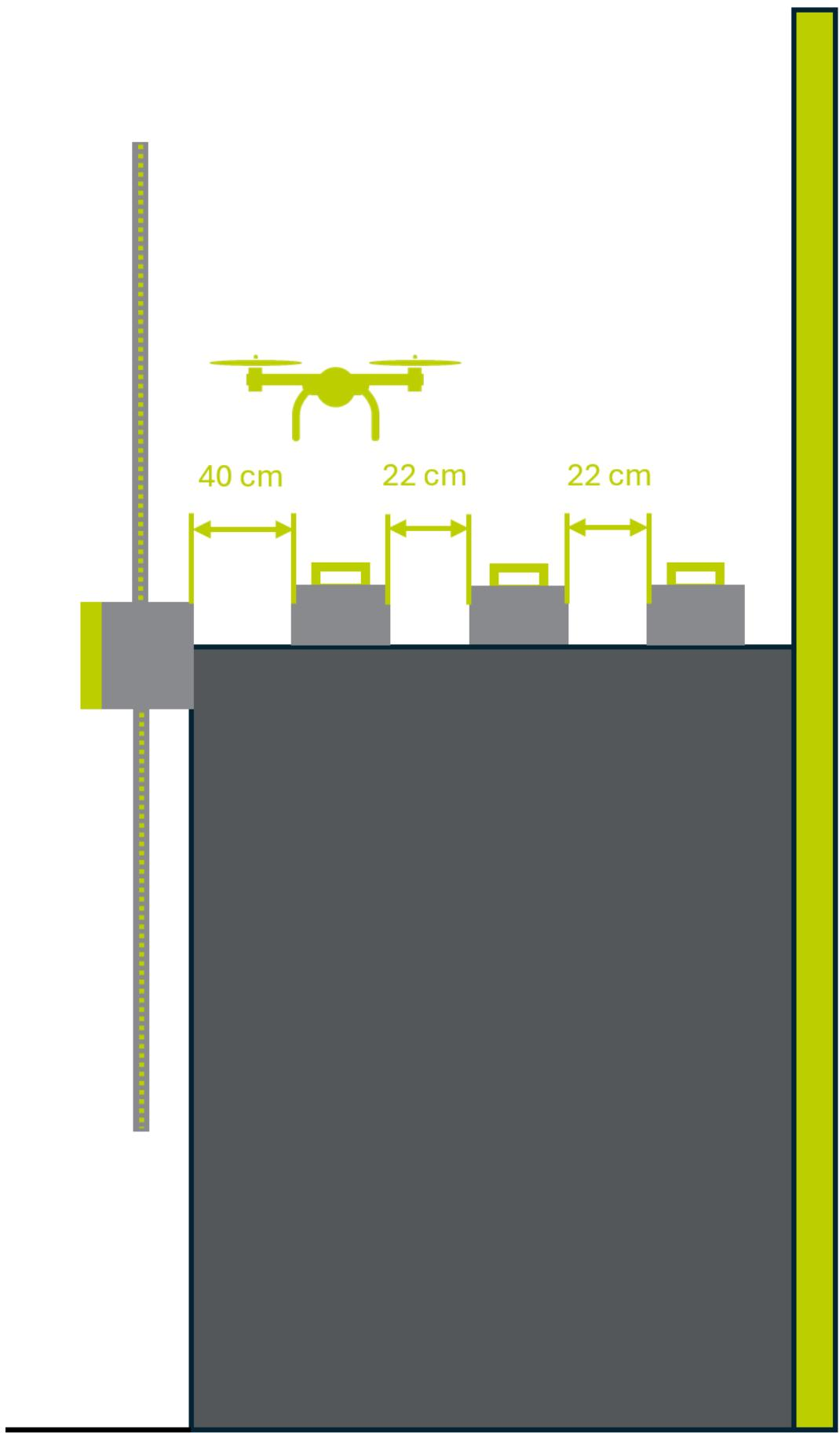
Por otra parte, indicar que las cajas estarán colocadas en cualquier posición cercana al eje de giro de la estructura móvil, pudiendo estar alineadas o no. En cualquier caso, la distancia máxima respecto al eje de giro será de 22 cm.
