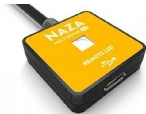
El módulo LED de la controladora Naza-M lite actúa como interfaz para la conexión USB del dispositivo al software de configuración (Naza Assistant), así como de indicador LED de incidencias mediante un código de colores y pulsos.
