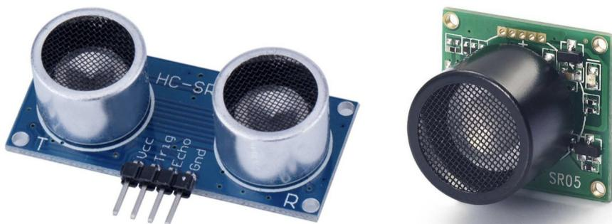
**Conexiones:** Los sensores de ultrasonidos pueden utilizar diferentes tipos de conexiones, dependiendo del modelo y de su aplicación específica. Uno de los modelos más extensamente usado es el HC-SR04, por su versatilidad y bajo coste. Requiere de un microcontrolador para funcionar, como por ejemplo Arduino, y funciona a 5V, que es el voltaje de la propia placa microcontroladora.
