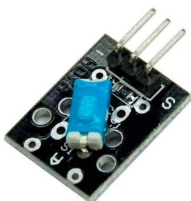
**Usos:** Estos sensores son comúnmente utilizados en proyectos de electrónica y robótica para detectar la orientación o posición de un objeto. Por ejemplo, se pueden usar para activar un actuador o para emitir una señal de alarma al inclinarse.
