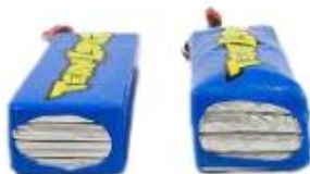
Aspecto batería en buen estado y batería inflada
