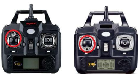
Una vez encendidos el control remoto y el dron, este no responderá a los movimientos del joystick hasta realizar la sincronización entre ambos. Para ello, se debe llevar el acelerador (joystick izquierdo) a su posición máxima (arriba) hasta escuchar un pitido y posteriormente a su posición mínima (abajo) hasta escuchar un segundo pitido. Se observará cómo los ledes dejan de parpadear.
