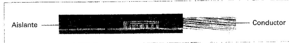
Figura 2.1. Constitución de un cable eléctrico.
