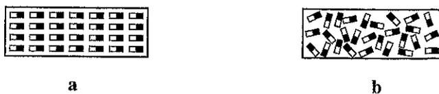
Figura 10.3. Moléculas magnéticas de un imán (a) y de un trozo de hierro (b).
