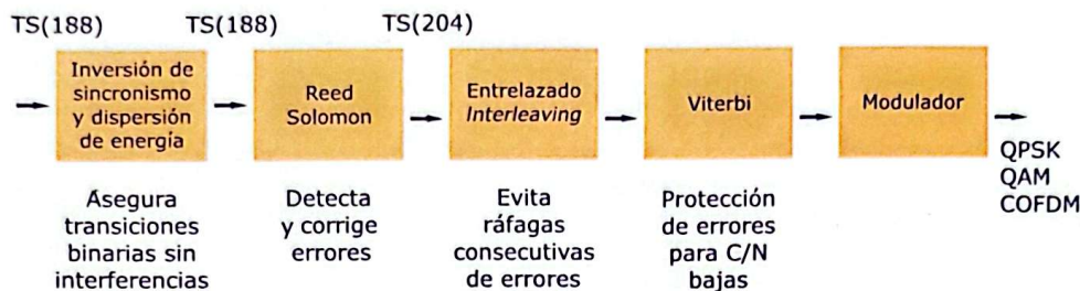
Figura 2.25. Proceso de detección o corrección de errores.
