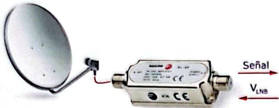
Figura 3.38. Conexión del amplificador de línea a LNB.
