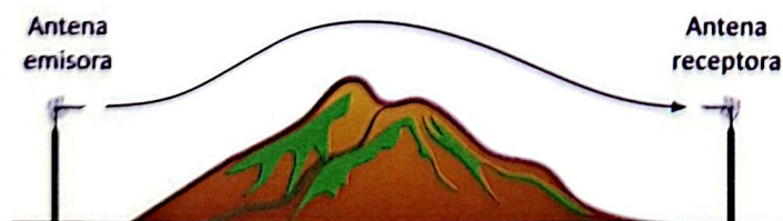
Figura 2.5. Difracción de las ondas.
