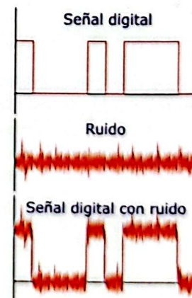
Figura 2.74. Composición de una señal con ruido.
