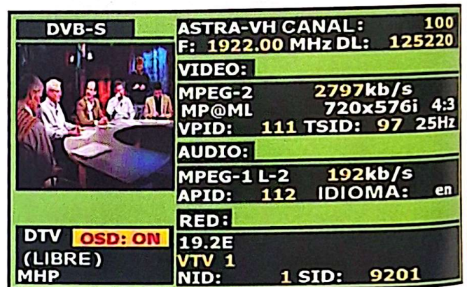
Figura 3.110. Información genérica sobre el canal sintonizado. (Cortesía de Promax).
