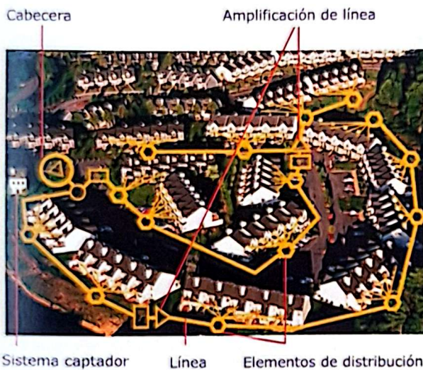
Figura 3.111. Ejemplo de transmisión por cable. (Cortesía de Televés).
