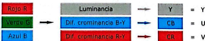
Figura 2.22. Componentes de la señal de vídeo. De RGB a YUV.
