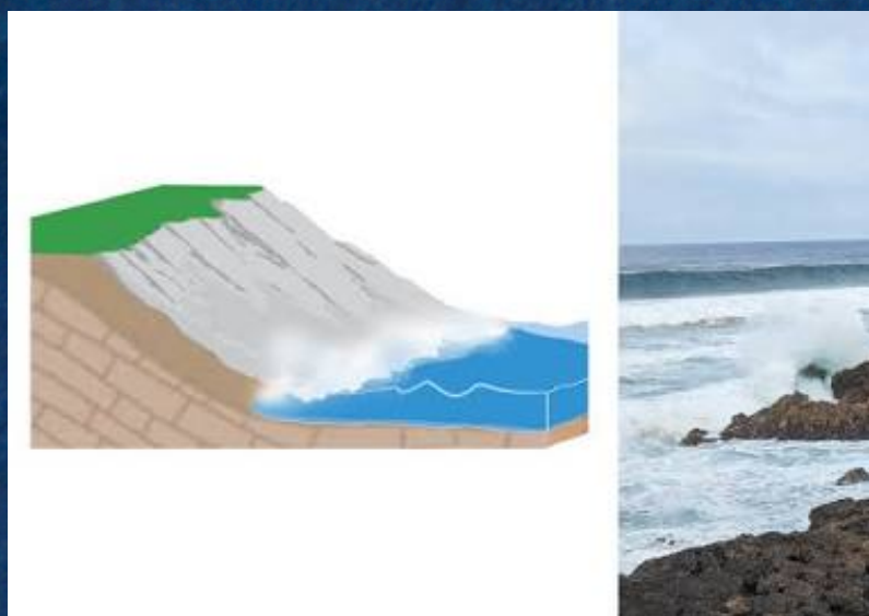
SOBREESCAVACIÓN DA BASE DO ACANTILADO
