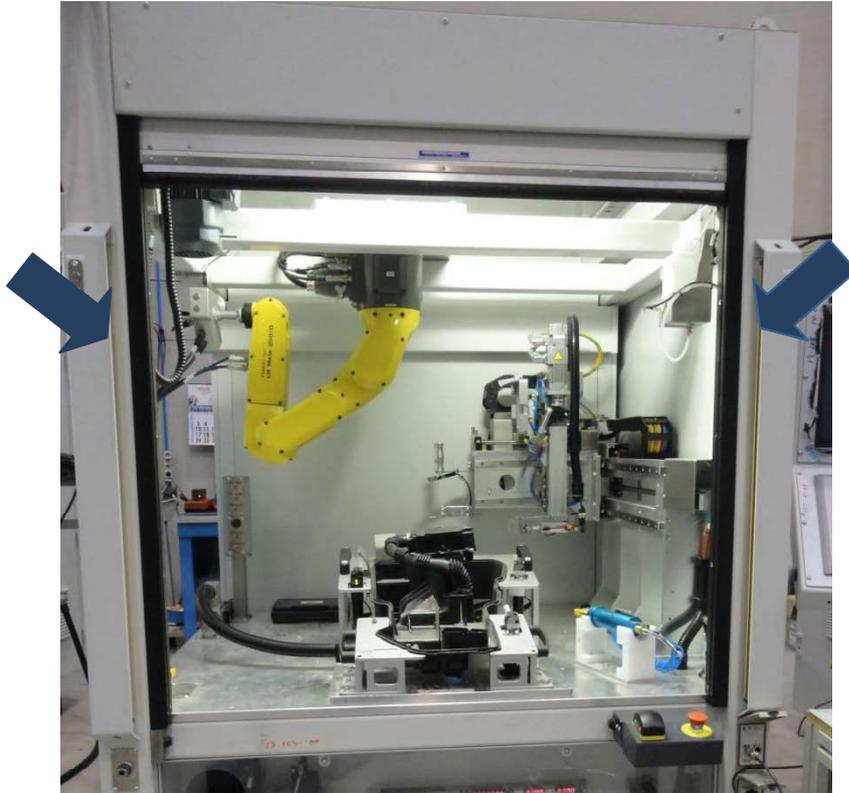
Ilustración 3: Barreras seguridad en máquina montaje bol
