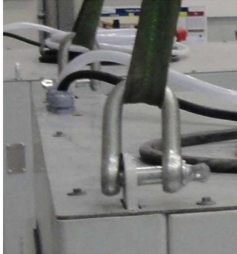
**Ilustración 3: Grillete y eslinga montados en cáncamo**
