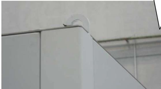
Ilustración 2: Cáncamo en bastidor máquina
