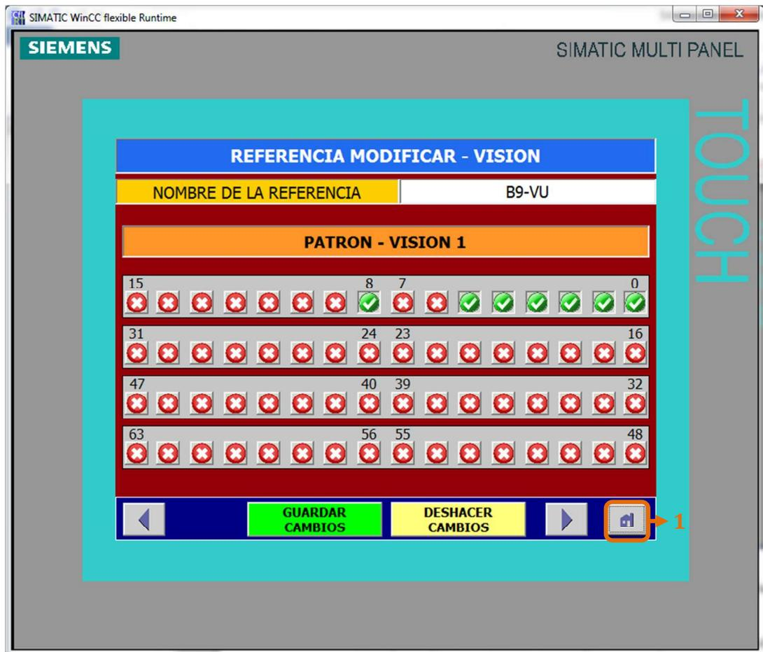
Mediante esta pantalla podemos parametrizar los controles a comprobar en el ciclo de visión en el paso patrones. Los controles no activos se ignoran.
